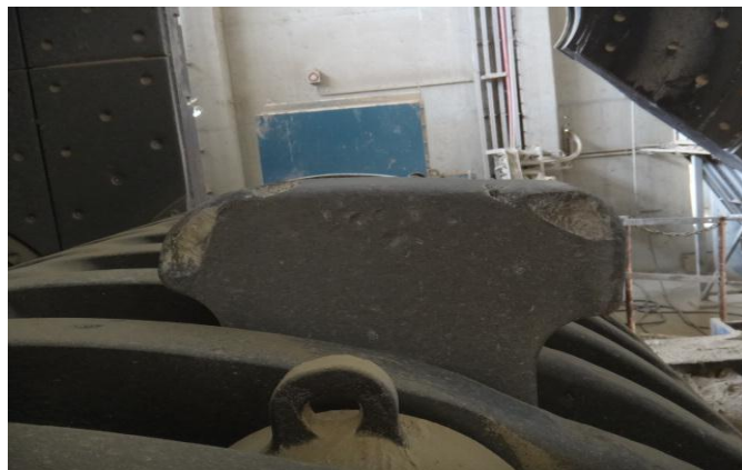
Fig. 43: Usure d'un marteau
