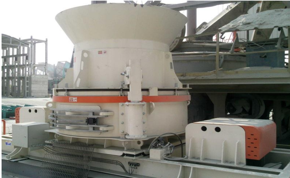
Fig. 32 : Concasseur à percussion à axe vertical
