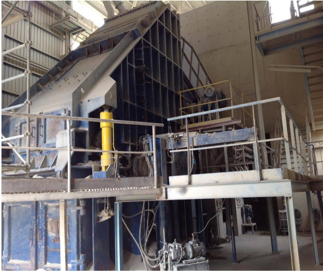
Fig. 36: concasseur a marteau EV 250
