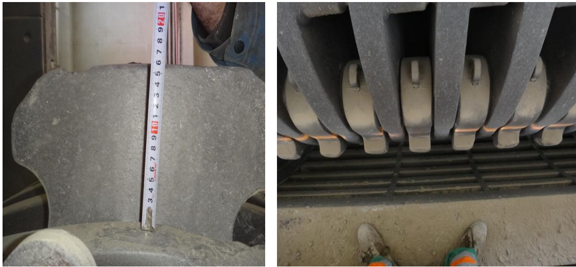
Fig. 40 : marteau de concasseur
