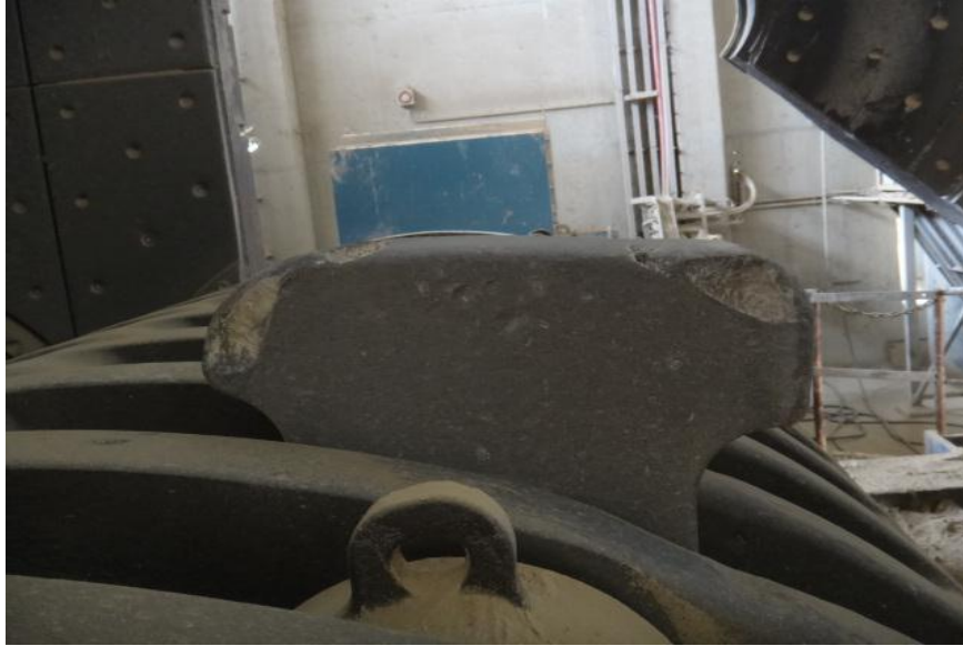
Fig. 42 : Marteau de concasseur EV250 usé
