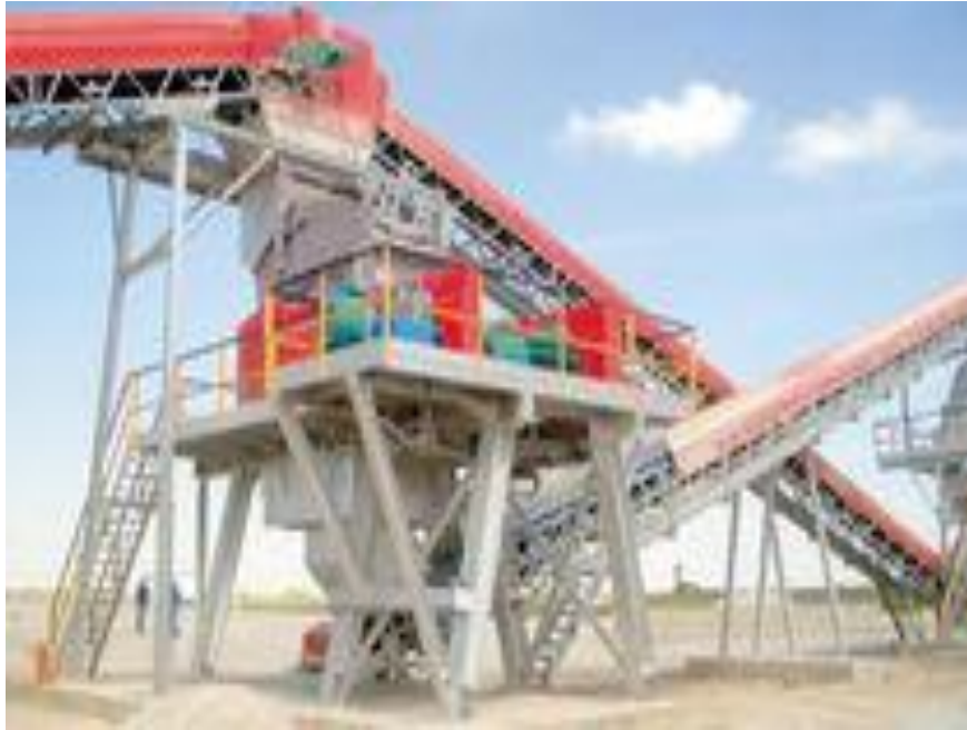
Fig. 31 : Concasseur à percussion à axe horizontal
